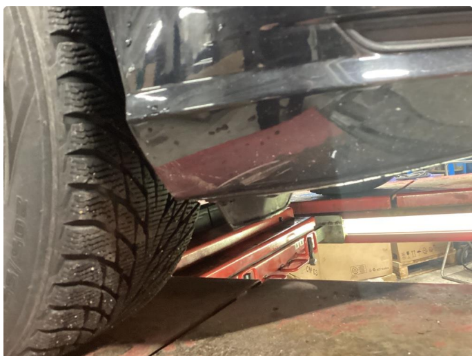
1.4 Ripe(r) ned til grunning
