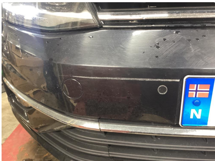
1.4 Ripe(r) ned til grunning
