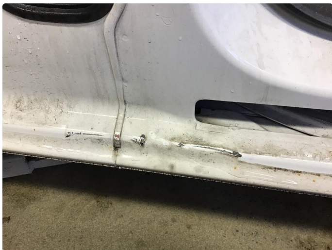
1.6 Bulk(er) med lakkskade
