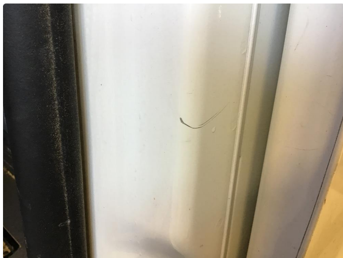
1.6 Bulk(er) med lakkskade
