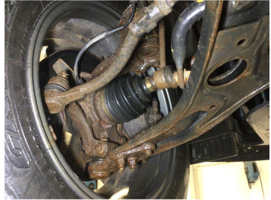
2.1 Overflaterust i forstilling, ingen tiltak kreves
