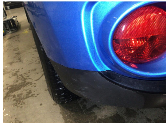
1.2 Riper og liten sprekk i bakfanger venstre side, dette blir utbedret
