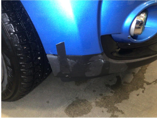
1.4 Frontfanger er sprukket i nedre del i plastikk på høyre side, dette blir utbedret
