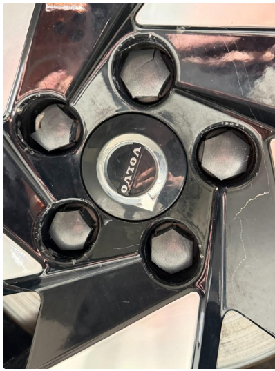
1.2 Skader på alle fire vinterfelger
