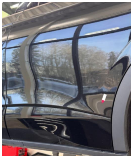
1.2 Liten steinsprut med korrosjon venstre bak.
