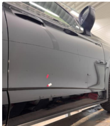
1.3 Liten steinsprut med korrosjon høyre fordør.
