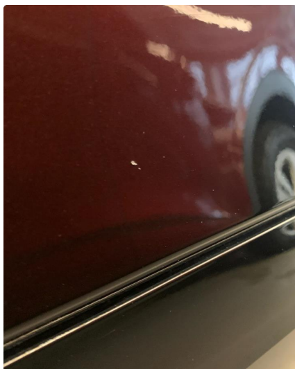
1.2 Liten steinsprut med korrosjon venstre fordør.
