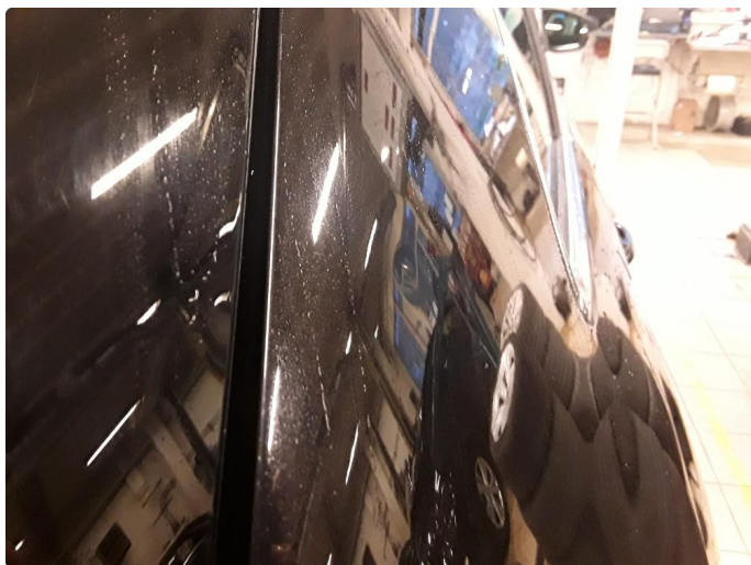
1.5 Liten bulk høyre bak. Blir forsøkt med bulkfix.
