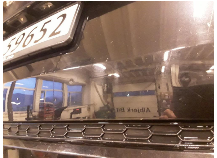
1.3 Noen bulker. Blir forsøkt med bulkfix. Liten steinsprut med korrosjon.
