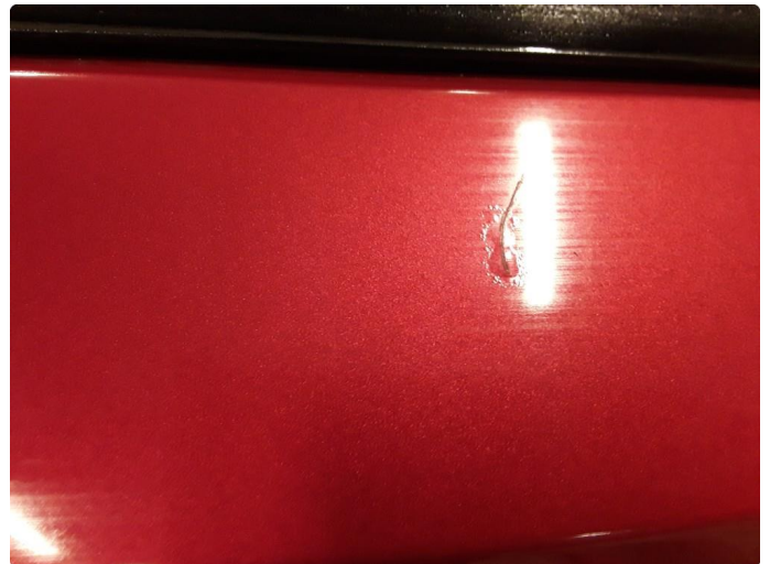
1.3 Liten steinsprut med korrosjon.
