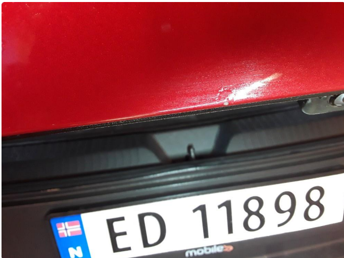
1.3 Liten steinsprut med korrosjon.
