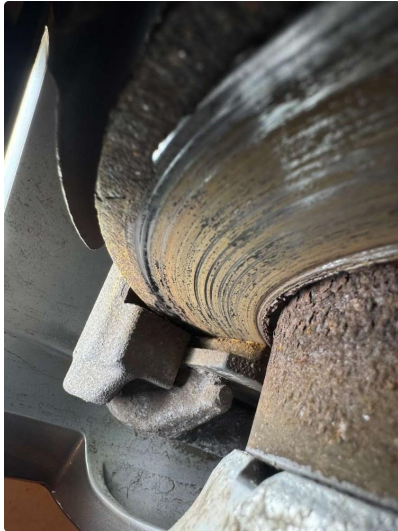
2.2 Rust, Blir byttet 7/11
