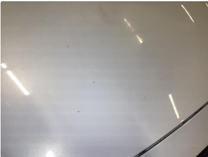
1.2 Steinsprut på panser bli utbedret
