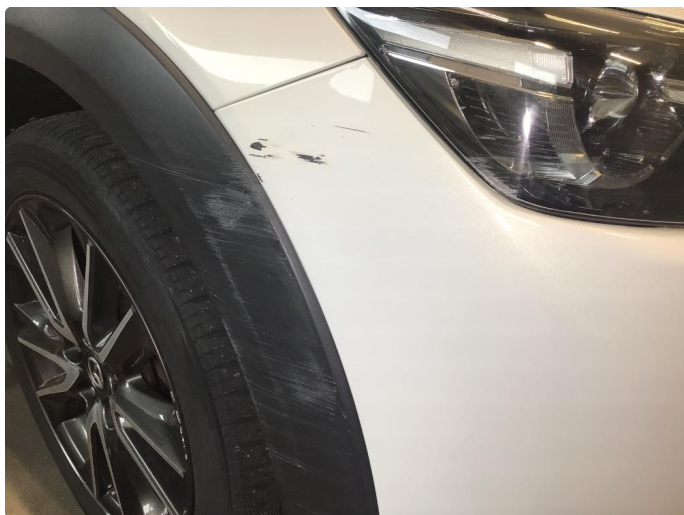
1.5 Riper på høyre side av frontfanger blir utbedret
