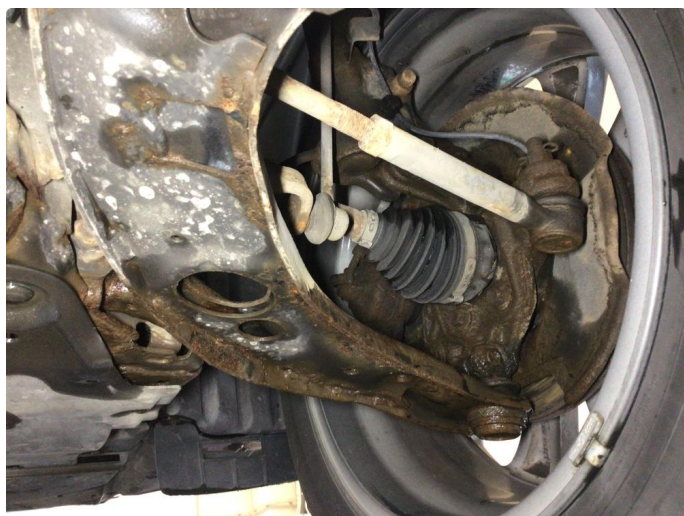
2.1 Overflaterust i forstilling, ingen tiltak kreves
