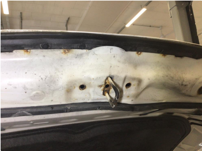
1.1 Noe korrosjon på innsiden av panser, dette av ubetydelig karakter
