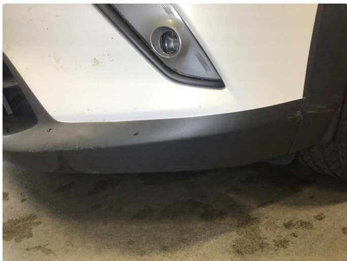
1.6 Noe skrubbb merker under frontleppe, dette av ubetydelig karakter
