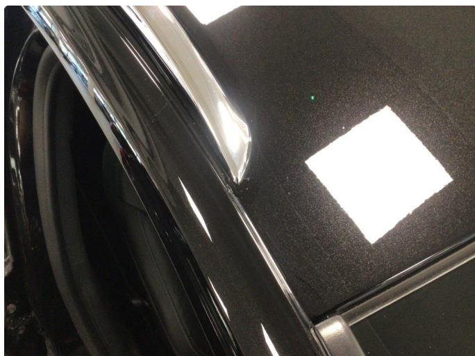
1.2 Noe korrosjon i framkant av takrails begge sider er utbedret
