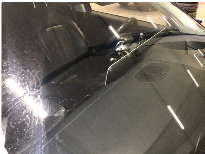
1.2 Noe steinsprut på frontvindu
