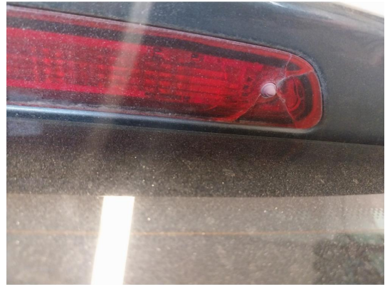
2.1 Defekt / sprukket glass
