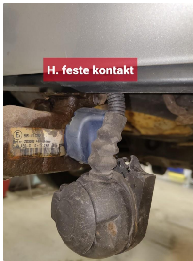
1.5 Tilhengerkontakt- innfesting skadet
