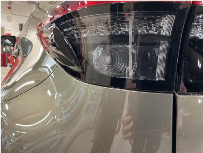
1.1 Sprekk venstre baklampe må skiftes prs kr.7 834,-ink mva
