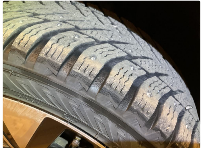
1.2 Nye vinterdekk med pigg montert
