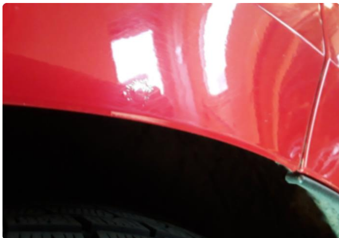
1.2 Liten steinsprut med korrosjon venstre bak.
