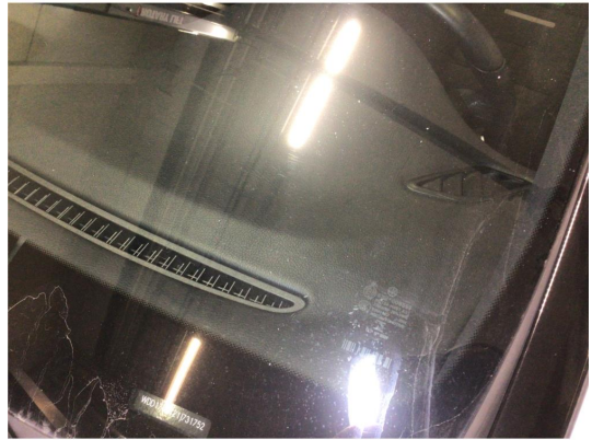
1.3 Noe slitasjeriper og steinsprut på frontvindu
