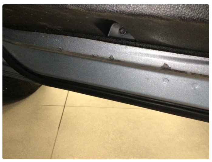
1.2 Noe korrosjon i fals og på innsiden av begge framdører
