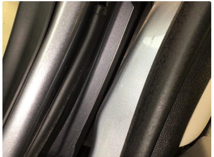
1.2 Noe korrosjon i fals og på innsiden av begge framdører
