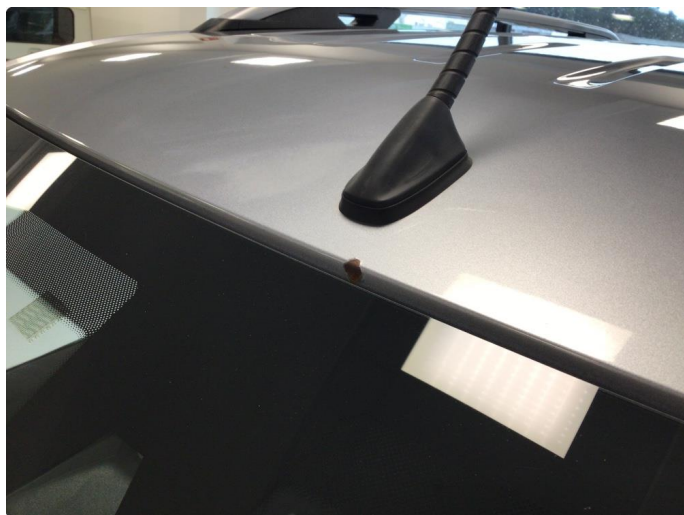
1.5 Korrosjon/rust flekk over frontvindu på tak
