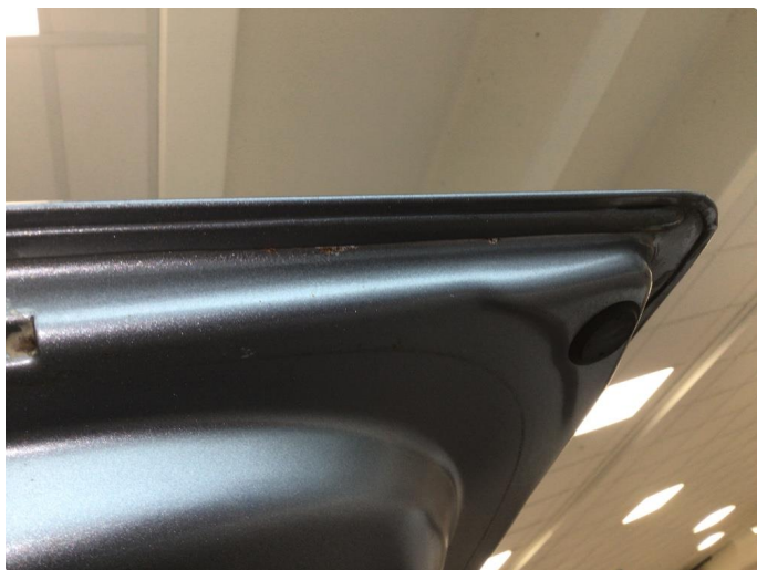
1.3 Noe korrosjon i fals på bakluke og under bakluke håndtak/skiltlysholder
