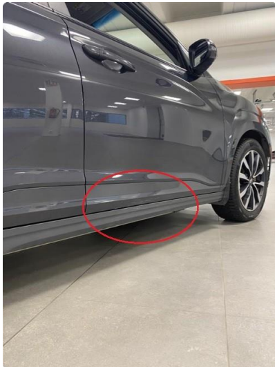
1.1 Overfladiske riper i bunn av høyre fordør og ned på kanal
