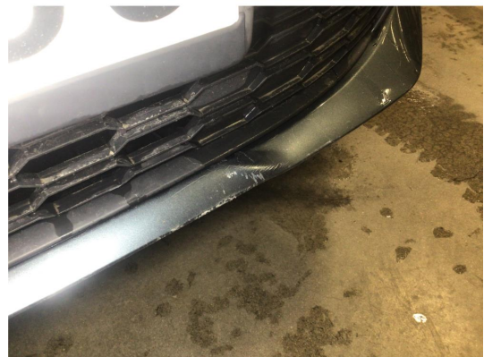
1.3 Merker og noe riper i frontleppe på frontfanger blir utbedret
