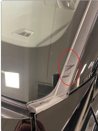
1.1 Vinduslist venstre side frontvindu.
