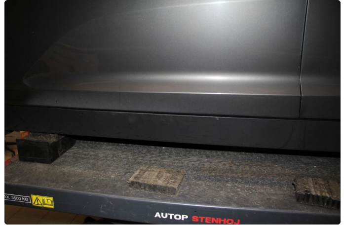
2.3 Noe steinsprut og matte felt nederst på alle 4 dører.
