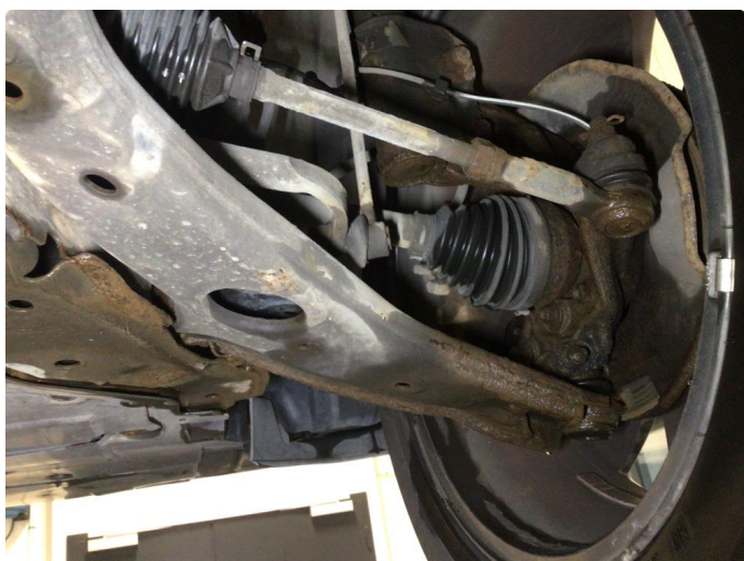
2.1 Overflaterust i forstilling, ingen tiltak kreves
