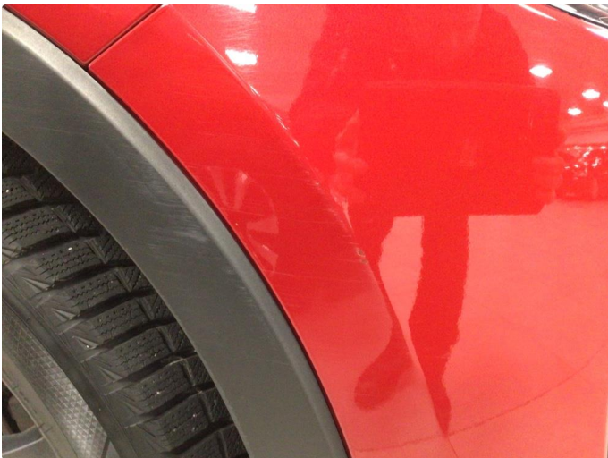
1.2 Noe overfladiske riper på begge sider av frontfanger og noe midt på bakfanger
