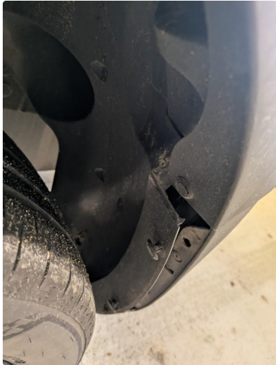
1.1 Plastinnerskjerm løs, Reparerer på forsikring
