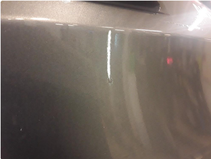
1.2 Liten steinsprut med korrosjon.
