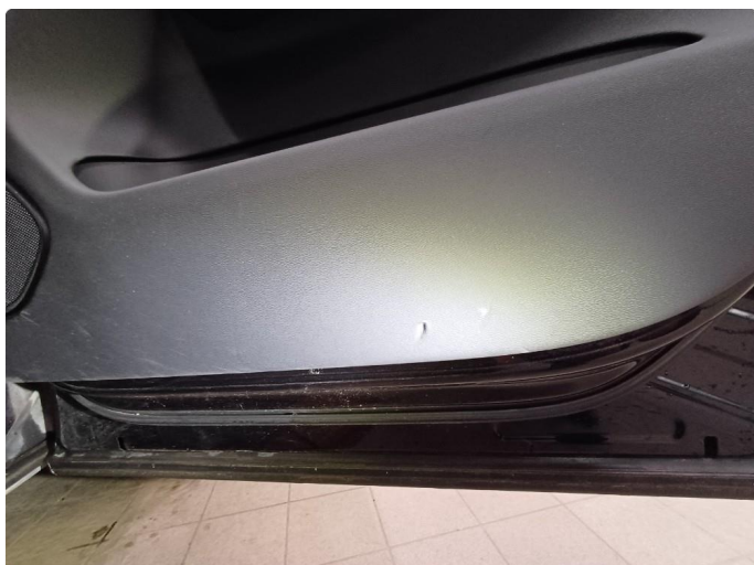
1.1 Slitasje innsiden av døren
