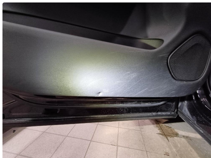
1.1 Slitasje innsiden av døren
