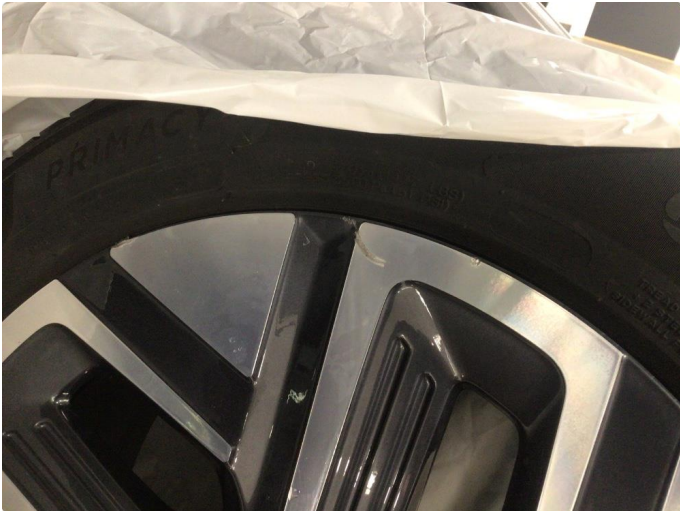
1.1 Kantkjørt en sommerfelg og en vinterfelg, vinterfelg er også noe oksidert
