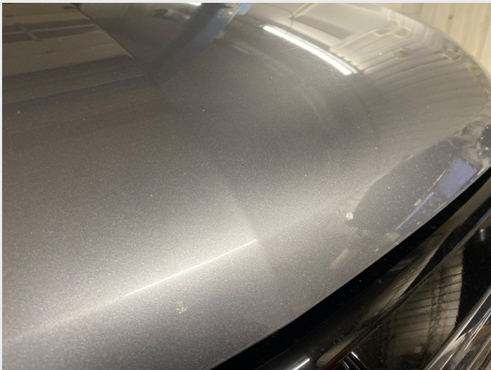
2.3 Steinsprut panser, flekket
