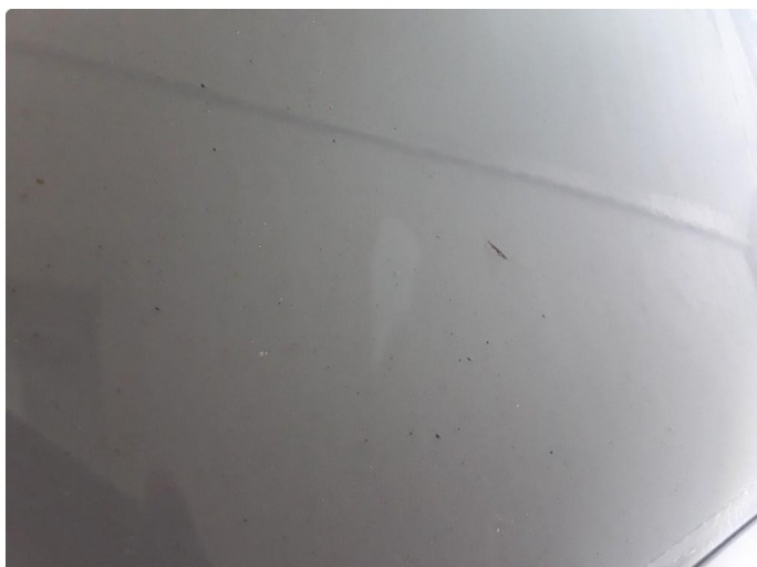
1.2 Liten steinsprut med korrosjon venstre fordør.
