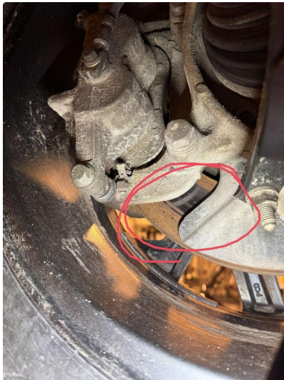
2.1 Rust, blir utbedret før salg
