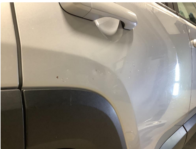
1.4 Bulk med lakkskade
