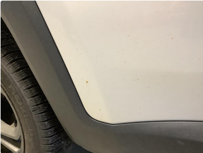
1.1 Forurensing lakk ytre påvirkning
