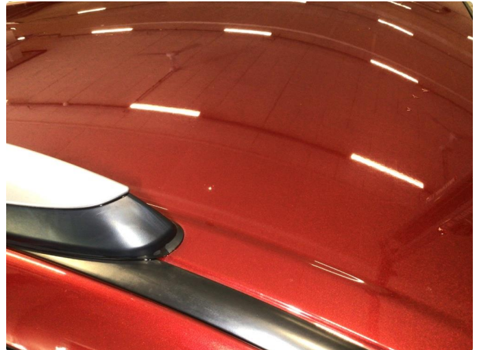
1.3 Noen små korrosjons flekker på tak
