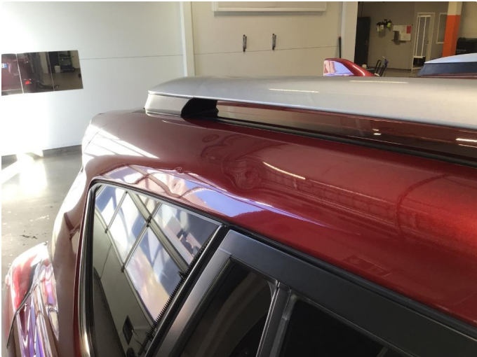
1.2 Små bulker på takvange høyre side blir utbedret noe med smart repair
