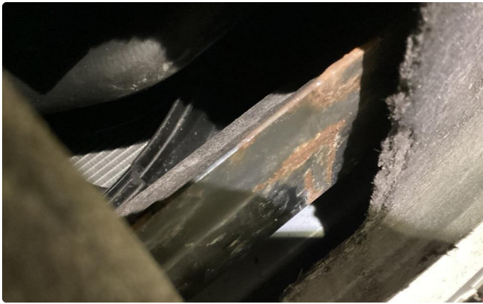
1.1 Det er liten bulk i travers foran
