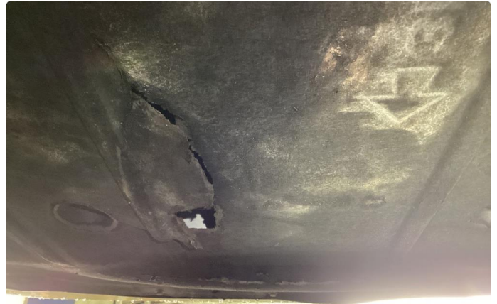
1.2 Beskyttelsesplate under motor er skadet
