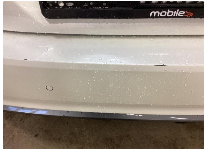
1.4 Ripe støtfanger bak
