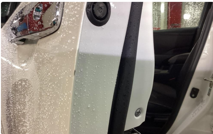
1.3 Liten avskalling dør VF
