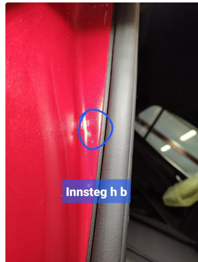
1.2 Noe riper i innsteg
