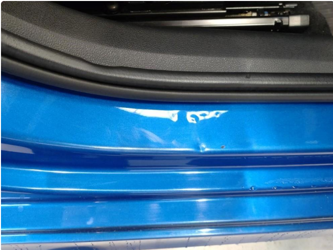
1.3 Bulk med lakkskade
