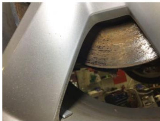
5.1 Noe rust på skiver foran og bak
