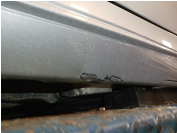
1.3 Sprekk i kanalskjørt / Plastikk
