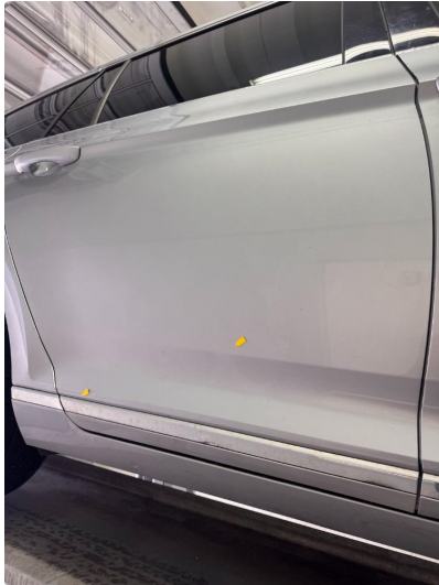
1.2 Noen små steinsprut med korrosjon.
