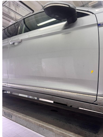
1.2 Noen små steinsprut med korrosjon.
