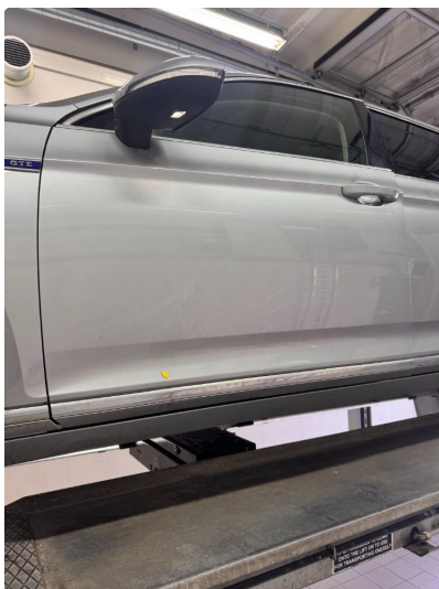
1.2 Noen små steinsprut med korrosjon.
