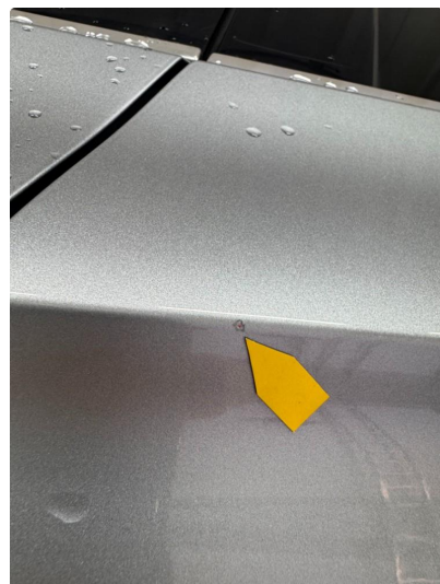
1.2 Noen små steinsprut med korrosjon.
