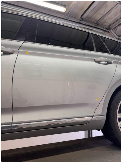
1.2 Noen små steinsprut med korrosjon.
