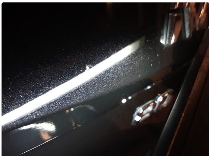
1.2 Noe steinsprut med korrosjon.
