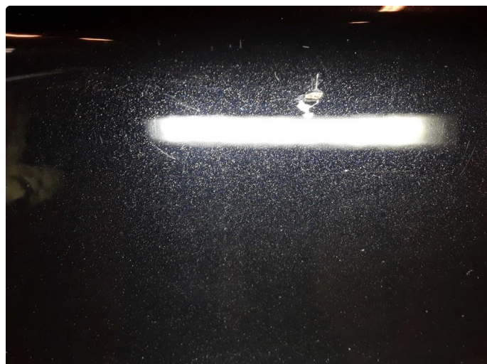
1.2 Noe steinsprut med korrosjon.
