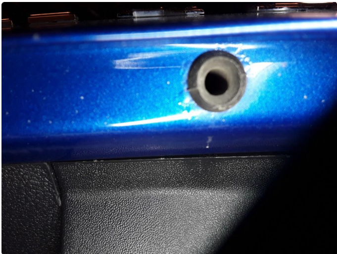
1.2 Noe korrosjon i underkant.
