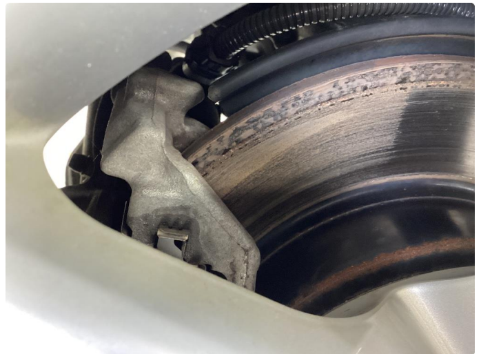
2.1 Rust. LITEN RUSTKANT.
