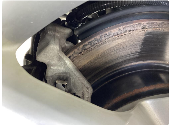
2.1 Rust. LITEN RUSTKANT.
