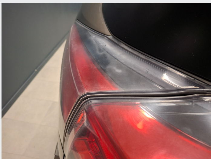
3.2 Baklykter er matte/merker (noe kondens/fukt i lykter)
