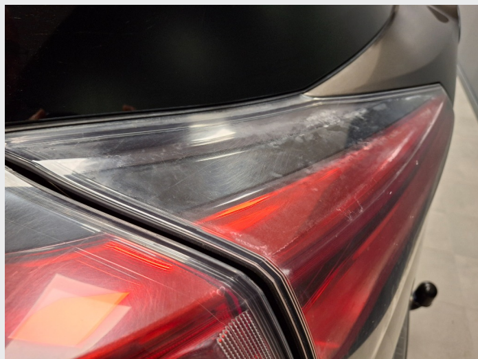
3.2 Baklykter er matte/merker (noe kondens/fukt i lykter)
