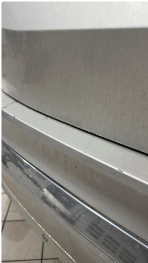
1.1 Ripe(r) ned til grunning
