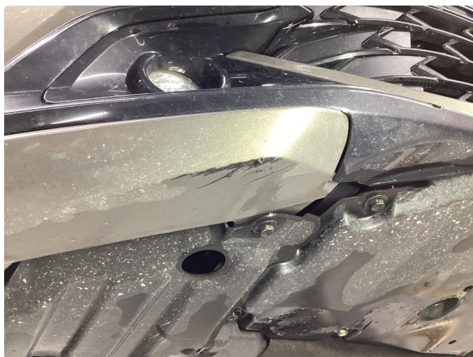
1.6 Skrubbskader underkant. UTBEDRINGER UTFØRT PÅ KLARGJØRINGEN.
