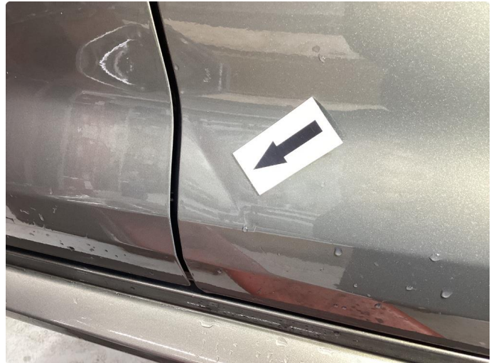
1.1 Bulk. UTBEDRES, BULK-FIKS VURDERES.
