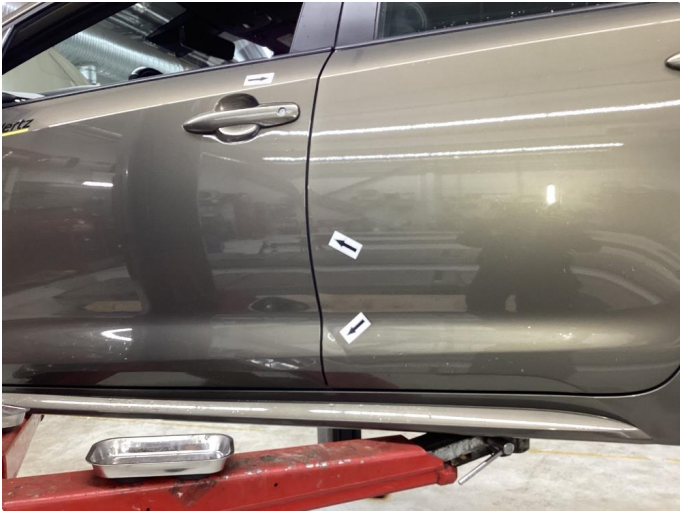
1.1 Bulk. UTBEDRES, BULK-FIKS VURDERES.
