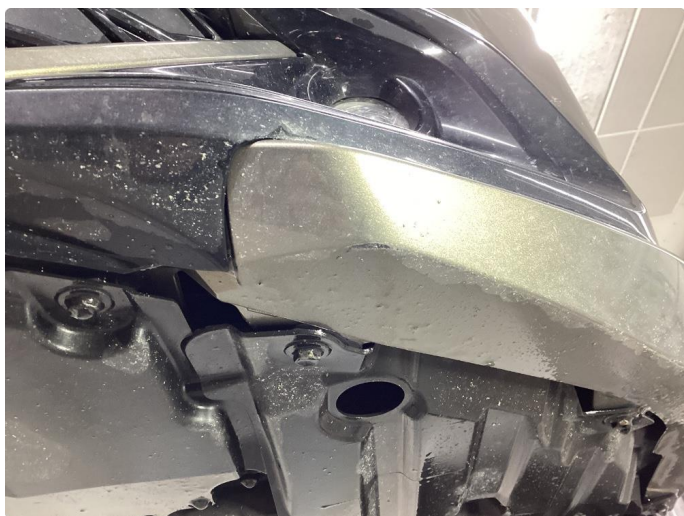
1.6 Skrubbskader underkant. UTBEDRINGER UTFØRT PÅ KLARGJØRINGEN.
