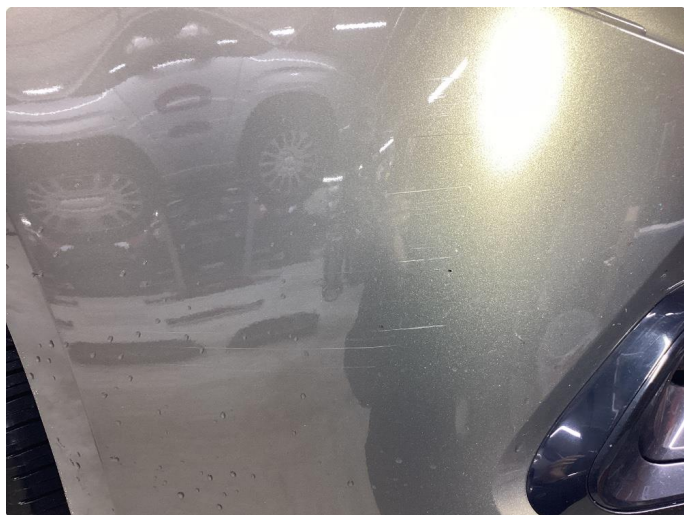
1.6 Skrubbskader underkant. UTBEDRINGER UTFØRT PÅ KLARGJØRINGEN.
