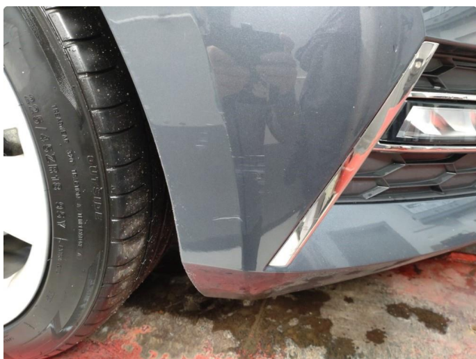
1.5 Ripe(r) ned til grunning
