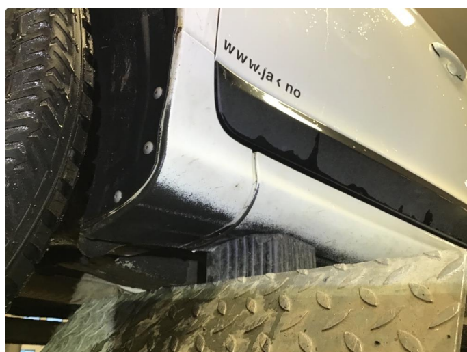
1.3 Matt/slitt lakk i sprutsone under sideskjørt, normal bruk
