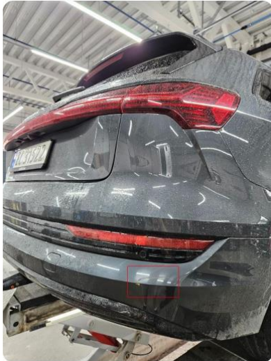
1.2 Riper nede på plast-støtfanger bak, h.side
