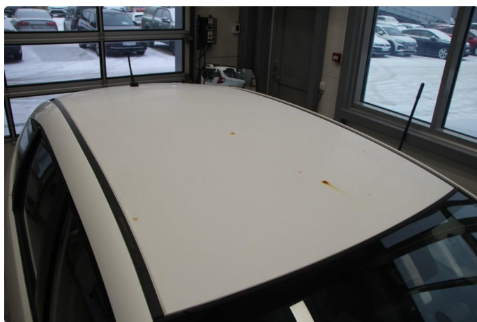
1.7 Flere rustflekker på tak og på langsgående takstolper ved døråpning.
