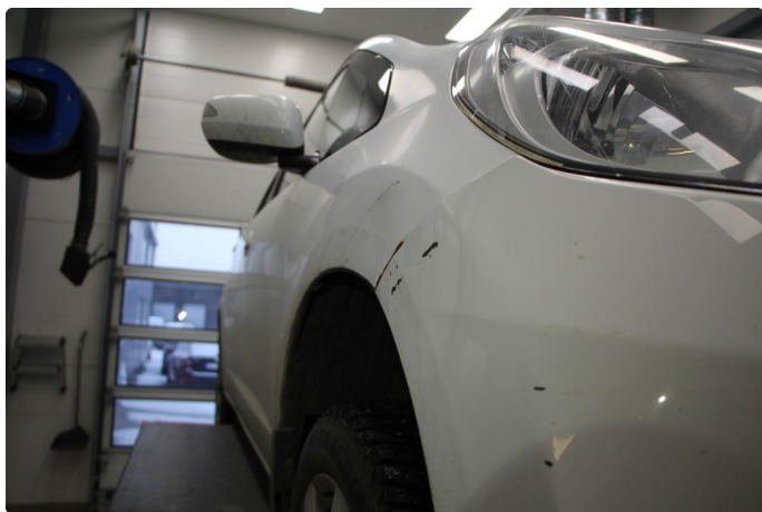
1.5 Skade med rust i skjerm, skrapeskade i støtfanger.
