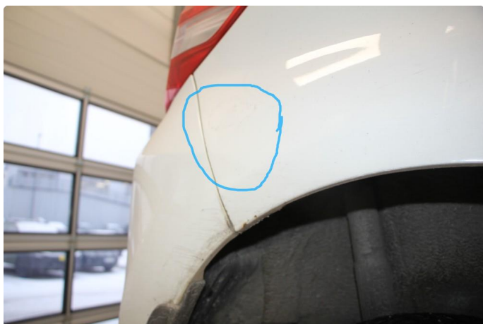
1.6 I forkant av hjulbue begge sider. Noe rart i lakk på skjerm høyre bak, denne har vært opplakkert.
